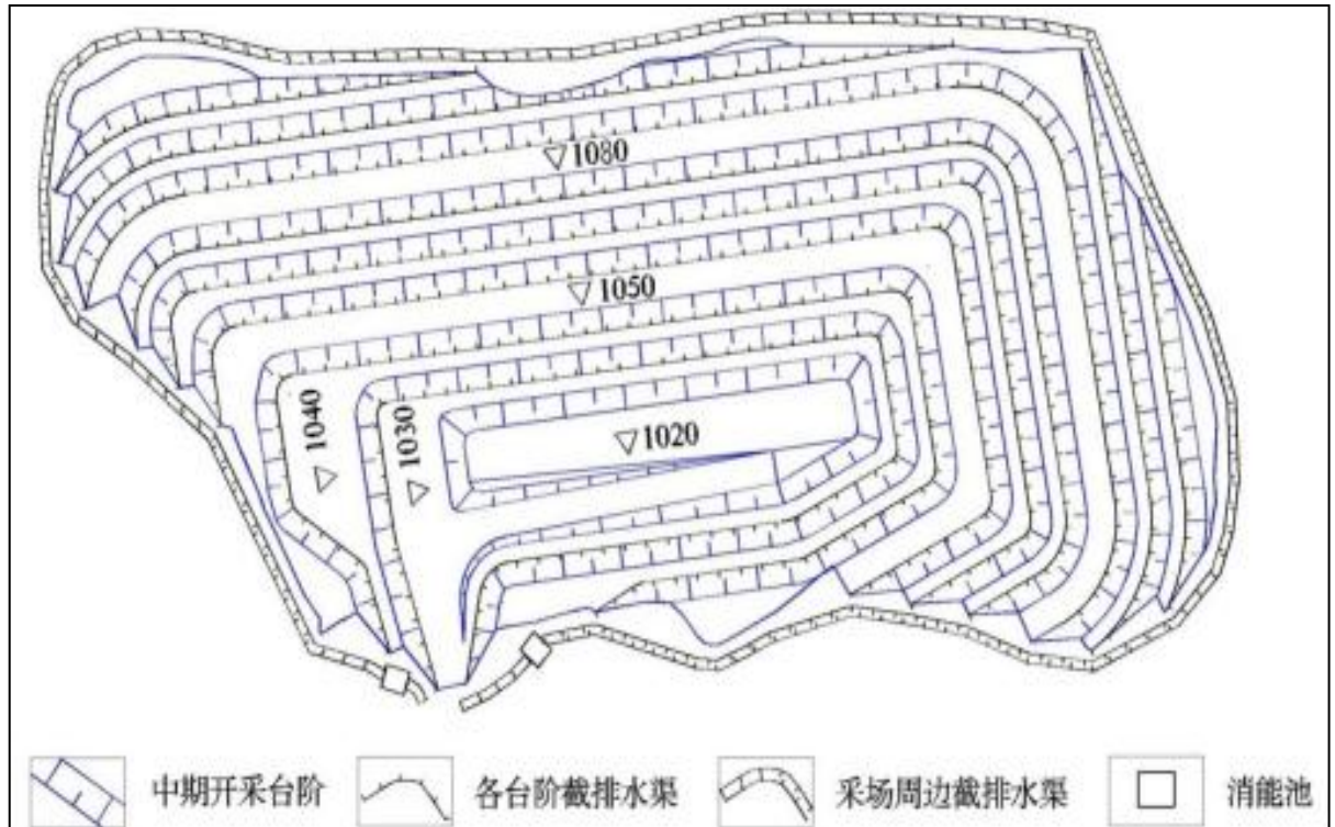
图 5-5 柏树梁采场截排水沟平面布置图
